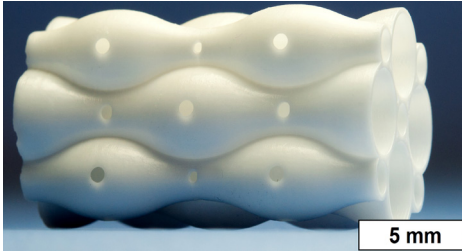
Abb. 5a: gesinterte Waben mit wechselnder Kanalgeometrie aus Al 2 O 3 (© Fraunhofer IKTS)
