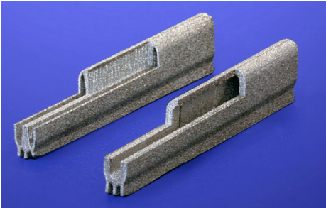
Querschnittsdarstellung der Heat pipes (Gitterabstand 100\ \mu\text{m} bei 20\ \mu\text{m} Schichtdicke). Links: Heat pipe-Aufbau mit Innenstruktur, rechts: Aufbau mit Außenstruktur (© Fraunhofer IFAM/Dagmar Fischer)
