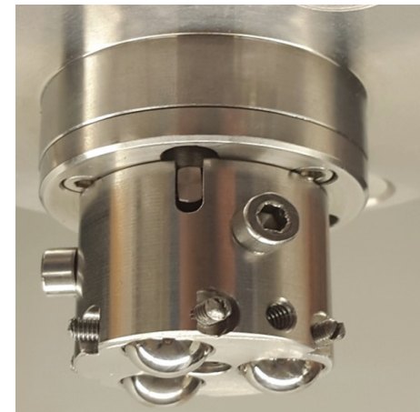
Abb. 1: Prüfmaschine für die Abriebprüfung. Neben den hier gezeigten Kugeln können auch Klingengeometrien eingesetzt werden, um unterschiedliche Belastungsarten nachzustellen. (© Fraunhofer IWM)
