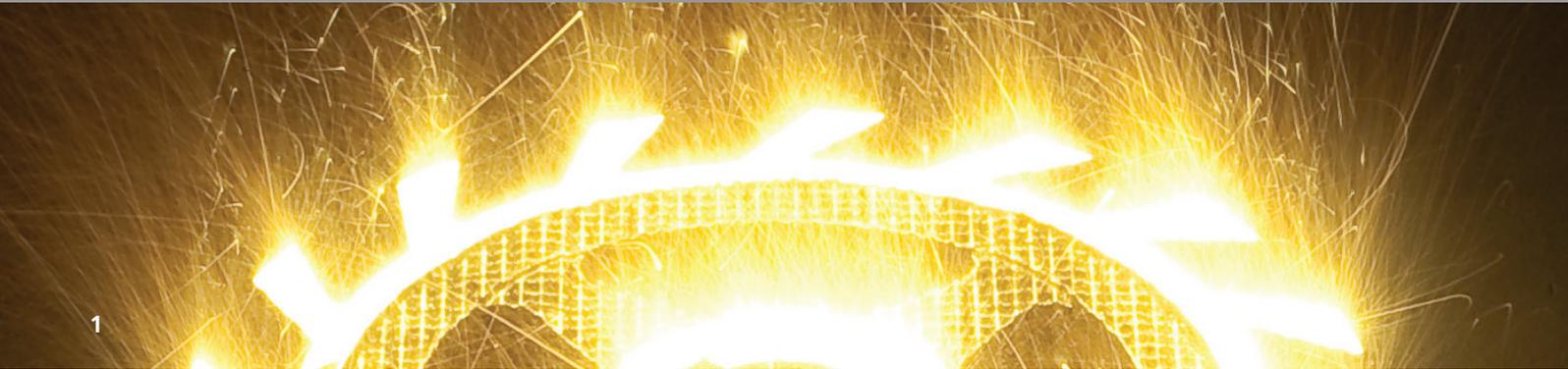
1 Belichtung eines Bauteils mit komplexer Innenstruktur
