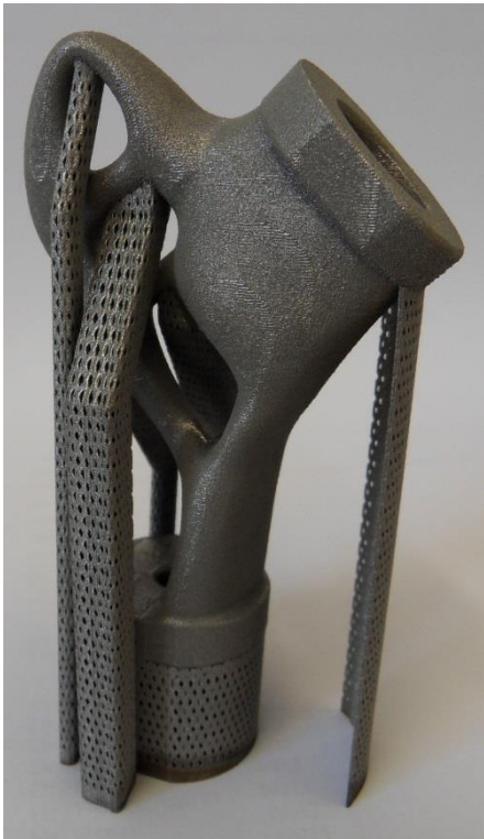
Abbildung 1: Halsmodul aus dem Werkstoff TiAl6V4 (Foto: Fraunhofer IWU)
