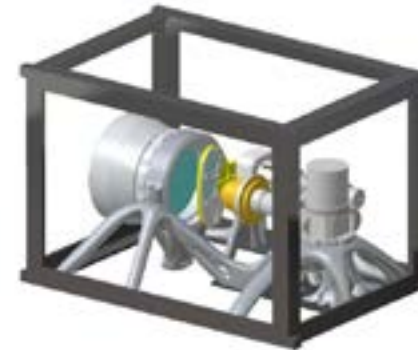
Abb. 2: Computermodell der integrierten optischen Nutzlast
