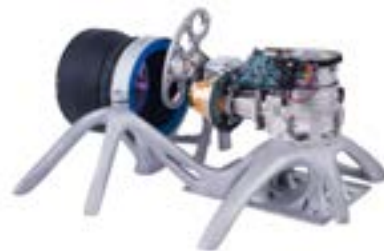
Abb. 1: 3D-gedruckte optische Bank des Nanosatelliten ERNST
