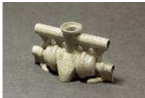
Abb. 1: Mit SEBM additiv gefertigtes, topologieoptimiertes Ventilgehäuse (Design aus Kooperation mit Bosch und TU Dresden)
