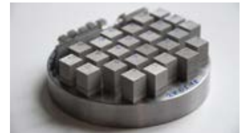
Abb. 2: Die Entwicklung von Fertigungsparametern für den LBM-Prozess, basierend auf hausinterner Methodik, ermöglicht den Einsatz von optimalen Werkstoffen für jeden Anwendungsfall.
