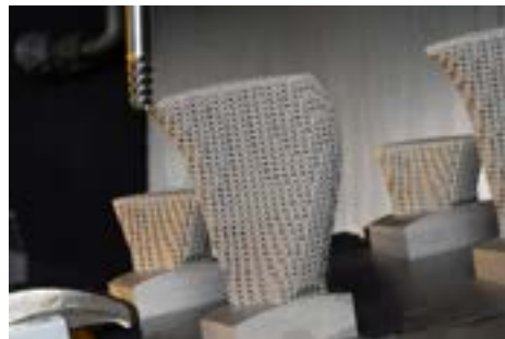
Additive Fertigung ermöglicht schwingungsarme spanende Weiterbearbeitung von Bauteilen
