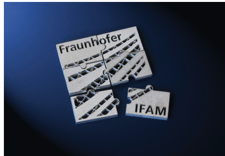
Abb. 1: Demonstratorbauteil für generative Fertigung durch 3D-Siebdruck
