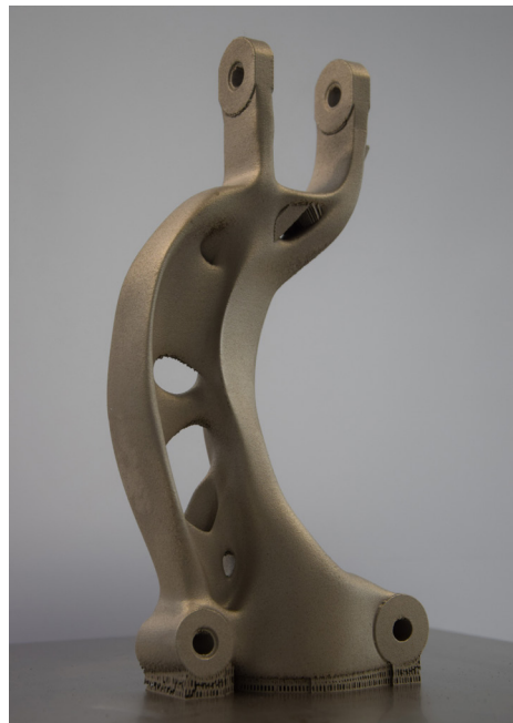
Abb. 1: Ressourcenoptimiertes Design einer KFZ-Dämpfergabel
