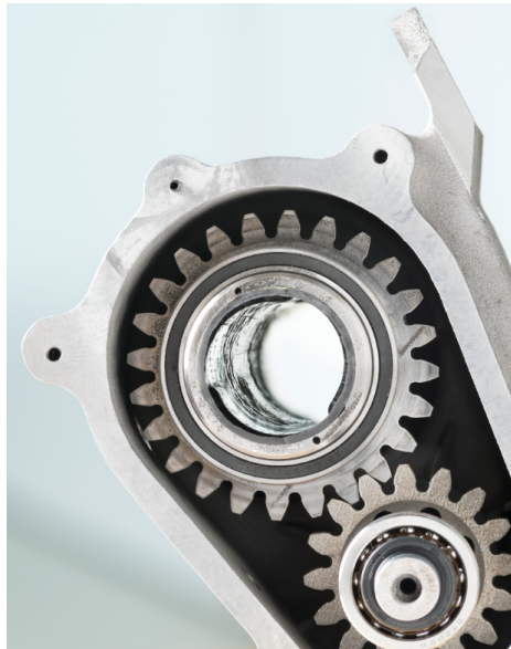
Abb. 1: Abbildung Multimaterial-Getriebe; Einzelteile hergestellt mittels Additiver Fertigung
