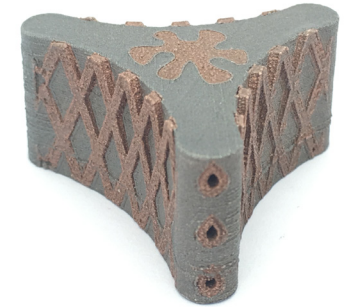
Abb. 1: Multimaterialbauteil aus dem Laserstrahlschmelzprozess aus Werkzeugstahl und Kupfer-Chrom-Zirkonium
