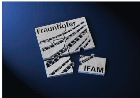
Abb. 1: Demonstratorbauteil für generative Fertigung durch 3D-Siebdruck
