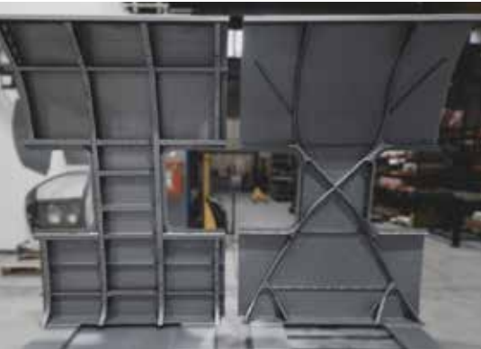
oben: Vollständiger Demonstrator mit topologieoptimierten Versteifungsstrukturen, hergestellt bei Photon AG.
