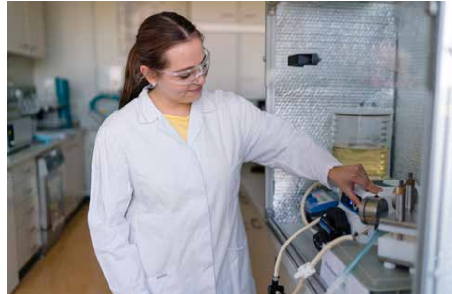
Reinigung der Produkte über Querstromfiltration
