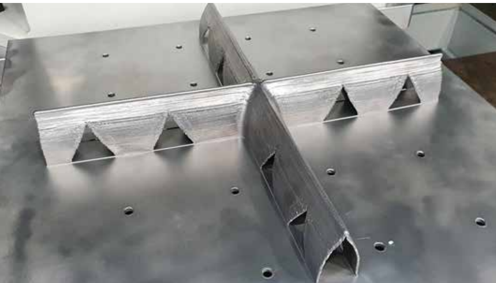
unten: Detail einer Versteifungsstruktur hergestellt durch drahtbasierten LMD-Prozess
